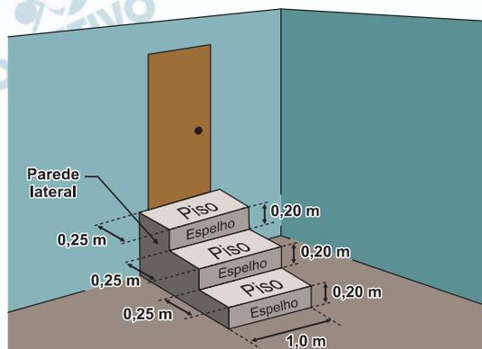
Nessa escada, pisos e espelhos têm formato retangular, e as paredes laterais têm formato de um polígono cujos lados adjacentes são perpendiculares. Pisos, espelhos e paredes laterais serão revestidos em cerâmica.
