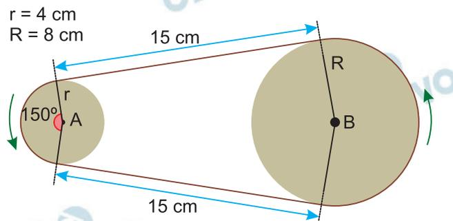
Para substituição dessa correia, é necessária a especificação de seu comprimento.
